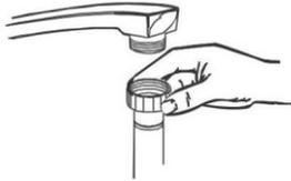
Подключите шланг для подачи холодной воды к соединительному колену с резьбой 3/4"; при этом следите за прочностью соединения.
